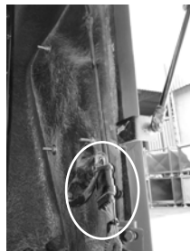
03 - Realizar la desconexión del conector eléctrico;
