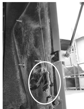
03- Realizar a desconexão do conector elétrico;
