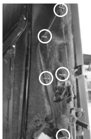
02 - Retirar las tuercas y arandelas que sujetan el farol.
