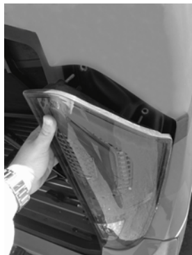
04- Realizar a retirada da lanterna;
